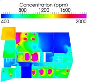
Modèle CFD - iso-contours CO2 h=1,5m
