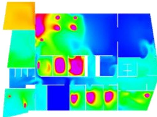
Modèle CFD - iso-contours CO<sub>2</sub> h=1,5m
